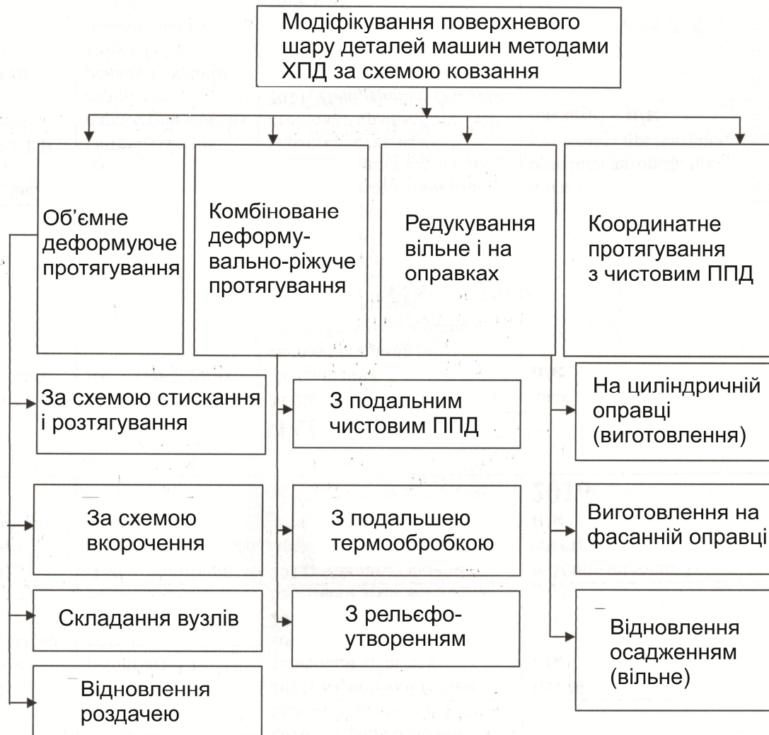
Рис. 2 – Класифікація за кінематикою найбільш ефективних методів модифікування поверхневого шару ДМ холодною пластичною деформацією за схемою ковзання
