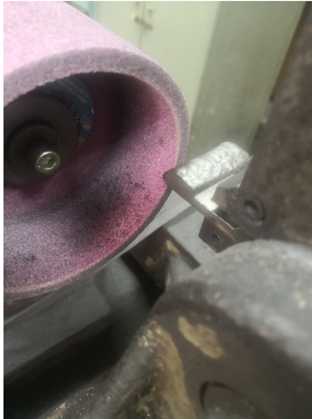
Рис. 1 – Шліфування наплавленого матеріалу абразивним кругом із хромистого корунду
