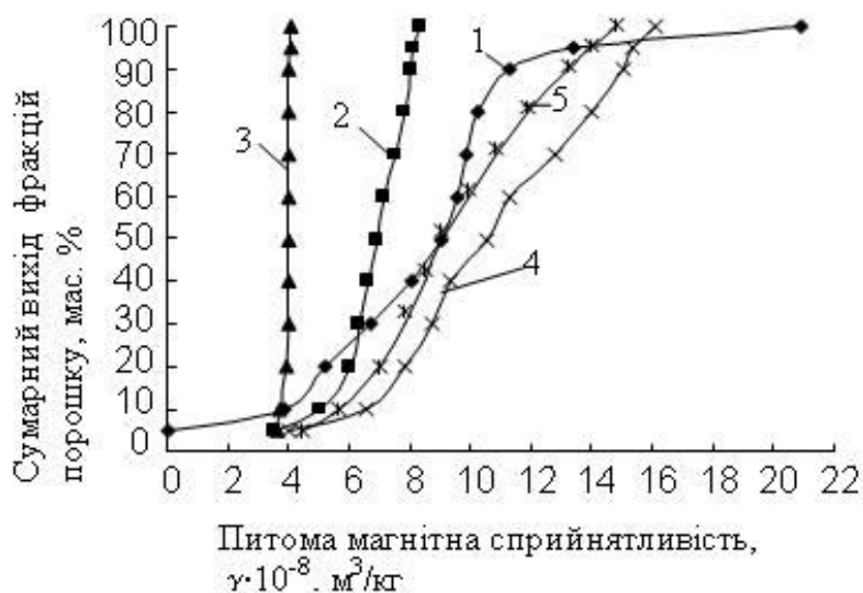
Рис. 1 – МФС вихідного порошку (1) та продуктів розподілу в інтервалі \chi = (3,6–8,3) \cdot 10^{-8} м 3 /кг: спосіб 1 (2), спосіб 2 (3); в інтервалі \chi = (4,0–16,0) \cdot 10^{-8} м 3 /кг: спосіб 1 (4), спосіб 2 (5)
