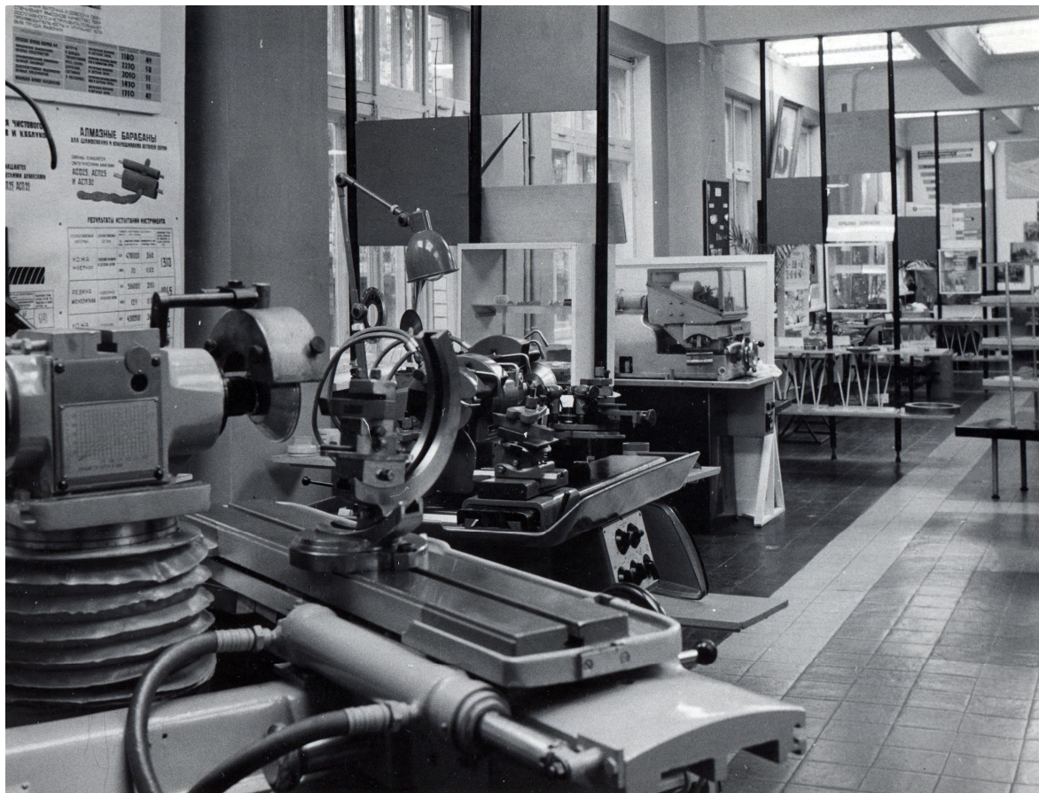
Рис. 1 – Перший поверх стаціонарної виставки Інституту надтвердих матеріалів. На передньому плані модернізований універсально-заточний верстат із гідроциліндром з літака МиГ
