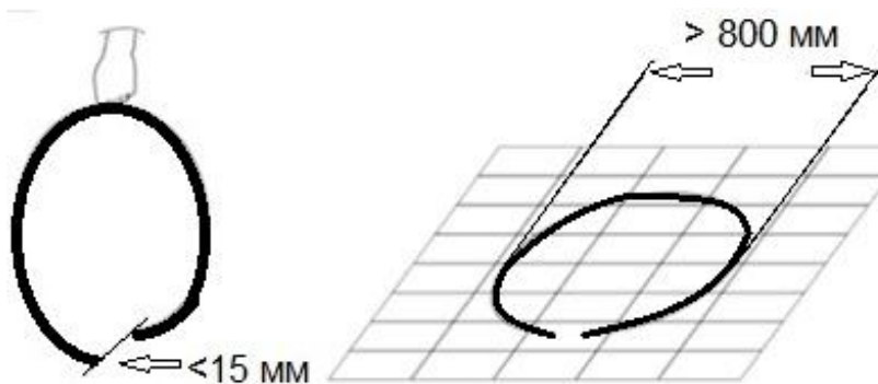
Рис. 2 – Вимоги EN до вільного діаметра витка
