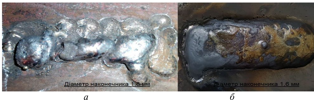
Рис. 1 – Зварки дротом з відхиленням по діаметру дроту з більшим наконечником 1,8 мм (а) і без відхилення по діаметру з наконечником 1,6 мм (б) в газі M21 (Ar+CO 2 )
