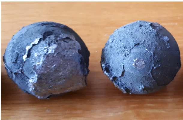
Рис. 1 – Внешний вид керамических заготовок после спекания и готовых шариков
