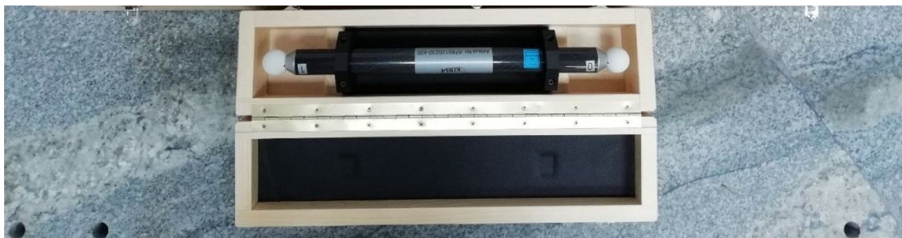
Рис. 1 – Эталон сравнения – мера координатная типа ball-bar в транспортировочном кейсе
