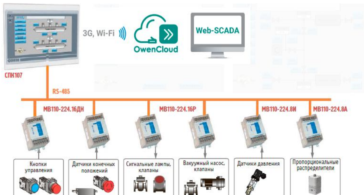
Рис. 1 – Структурная схема системы контроля и управления процессом пайки
