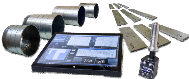
Рис. 2 – Портативный прибор ТПЦ-ФЛЕКС
