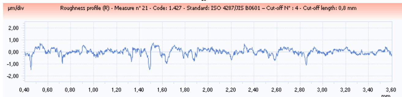
Рис. 3 – Профілограми шорсткості поверхні шестерень до (а) та після (б) зубохонінгування
