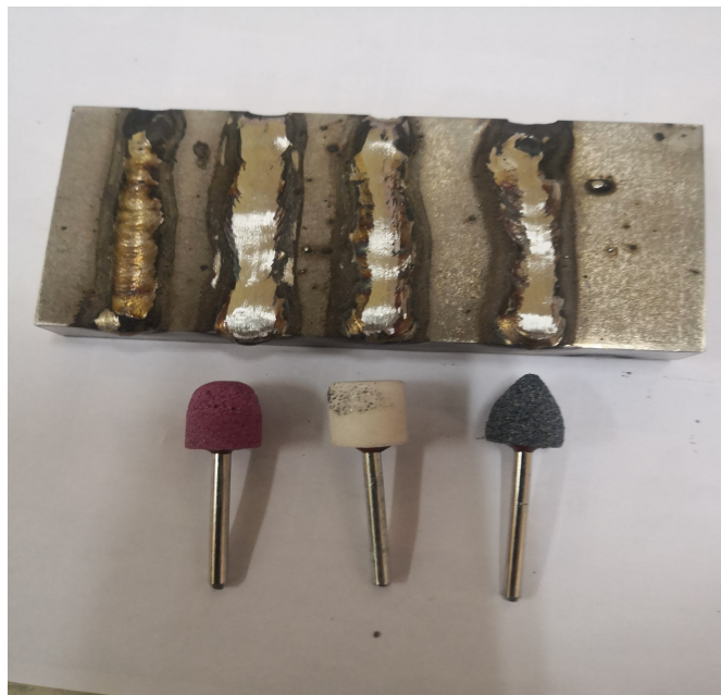
Рис. 4 – Вид шліфованих наплавлених валиків оброблених різними абразивними головками
