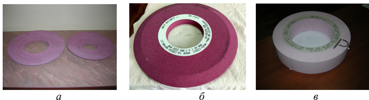
Рис. 1 – Шлифовальные круги из хромистого корунда:
