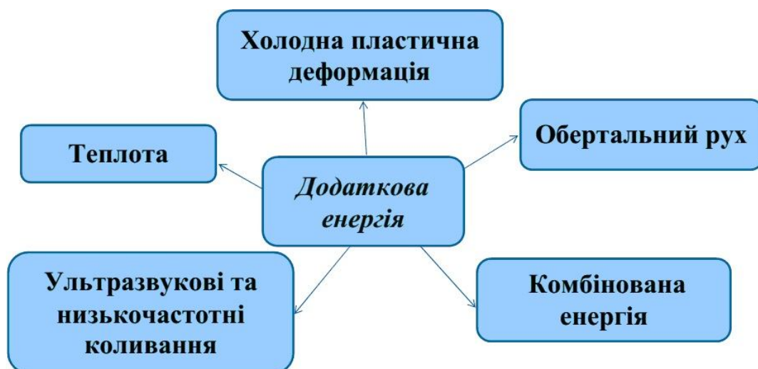
Рис. 1 – Види додаткової енергії, що вводяться у зону протягування
