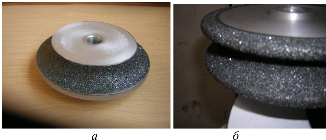
Рис. 1 – Инструмент для шлифования изделий из поролон: а – круги формы 1FF6; б – круги формы 2FF6
