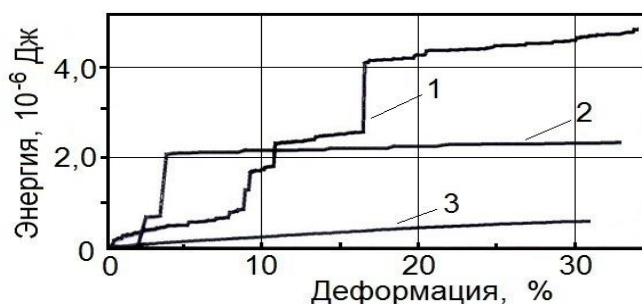
Рис. 7 – Изменение суммарной энергии импульсов АЭ при статическом растяжении трип-стали с содержанием мартенсита деформации 0% (1), 56% (2); 100% (3)
