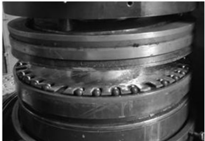
Рис. 2 – Розташування керамічних куль у сепараторі з відкритими пазами
