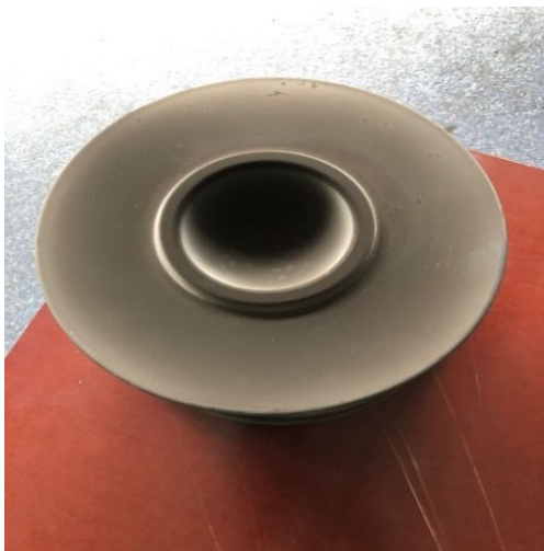
Рис. 2 – Штамповий інструмент – матриці для гарячого пресування: до азотування ( а ) та азотована ( б )
