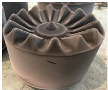
Рис. 3 – Зміцнений зубчастий пуансон для оброблення заготовок деталей
