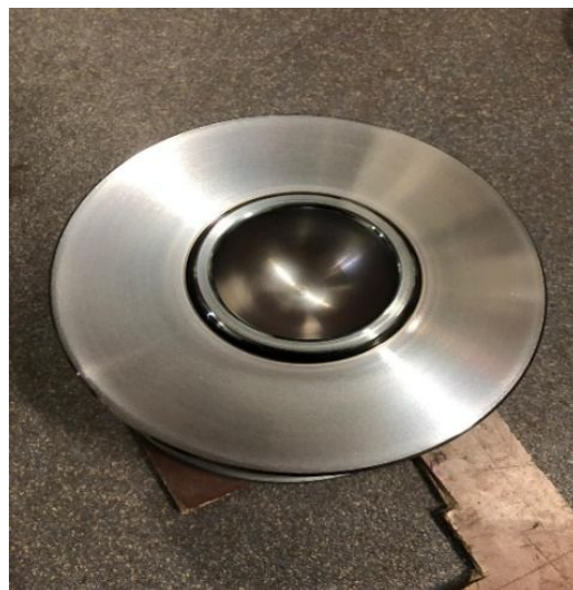
Рис. 2 – Штамповий інструмент – матриці для гарячого пресування: до азотування ( а ) та азотована ( б )
