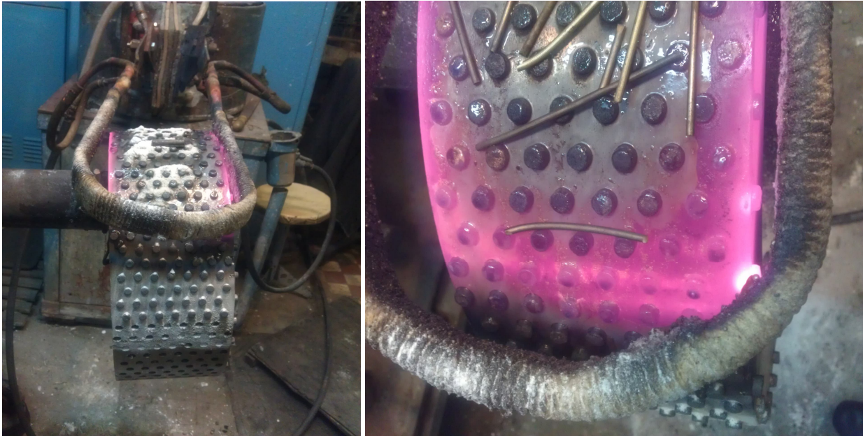
Рис. 3 – Зображення барабану шліфувального на операції ручного запаювання алмазовмісних твердосплавних вставок з підігрівом на установці ТВЧ
