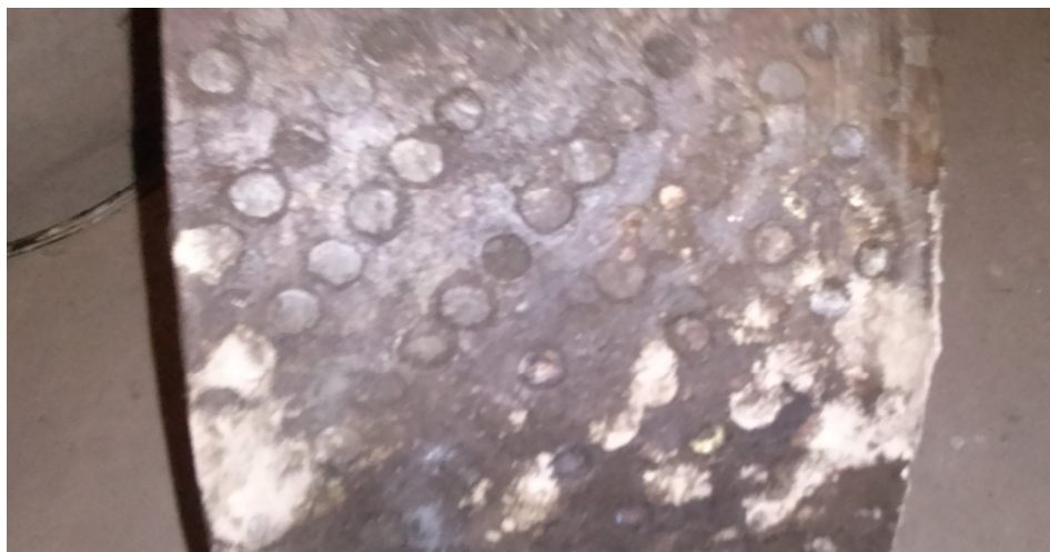
Рис. 4 – Фрагмент дефектної частини шліфувального барабана
