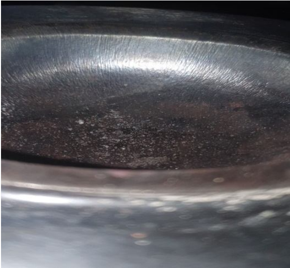
Рис. 1 – Зношена матриця для штампування сталевих куль, яка використовуються для розмелювання матеріалів після впливу термоциклічних навантажень
