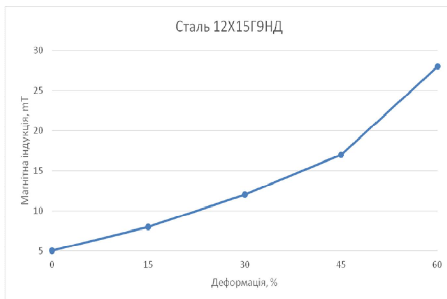
Рис. 3 – Графік залежності зміни магнітної індукції від ступеню деформації сталі 12Х15Г9НД
