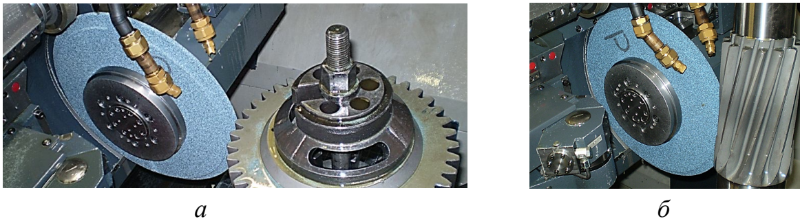
Рис. 1 – Установка шліфувальних кругів WG946Hs12Vs (а) та 3SG46Hs12Vs (б) на зубошліфувальному верстаті з ЧПУ HÖFLER RAPID 1250
