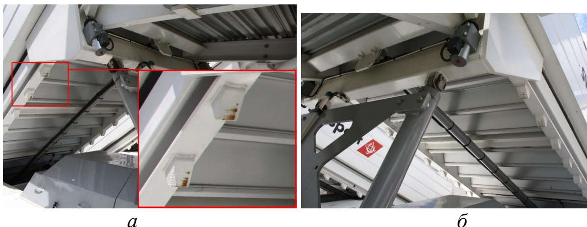
Рис. 1 – Результат избыточного изнашивания опорных зубов фиксации секции самоходного пассажирского трапа ABS 580 фирмы TLD: а – изнашивание правой стороны; б – изнашивание левой стороны
