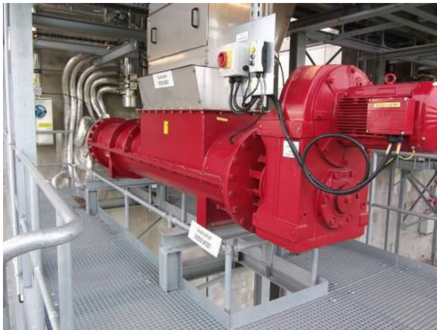
Рис. 1 – Шнековый пресс для обезвоживания сброженного субстрата после биогазовой установки
