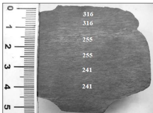
Рис. 1 – Темплет, вырезанный из наплавленного фрагмента рельса, с указанием твердости НВ
