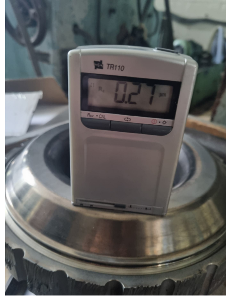
Рис. 1 – Обробка фрагменту диска авіаційної турбіни:
