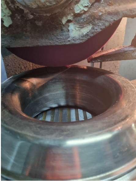
Рис. 1 – Обробка фрагменту диска авіаційної турбіни:
