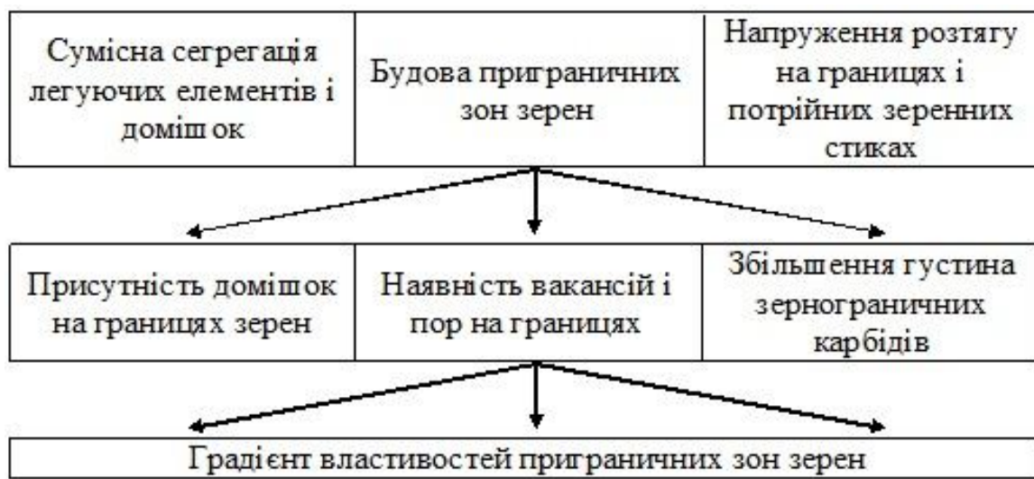
Рис. 1 – Фактори, що сприяють утворенню міжзеренних пошкоджень та інтеркристалітному руйнуванню сталей деревообробного інструменту
