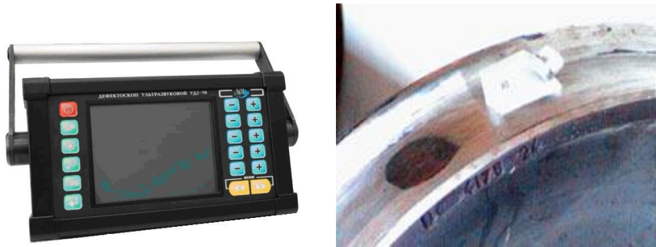
Рис. 1 – Загальний вид ультразвукового дефектоскопа УД2-70 та п'єзоелектричного перетворювача для перевірки поверхні кочення
