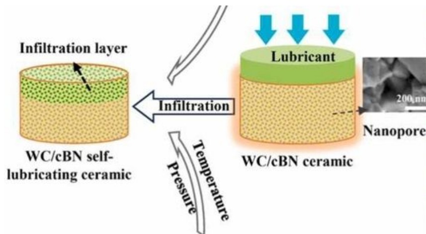
Рис. 2 – Схема формування самозмащувальної WC/cBN кераміки [2]
