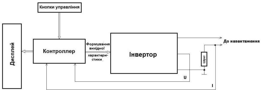
Рис. 1 – Структурна схема системи управління зварювального джерела живлення
