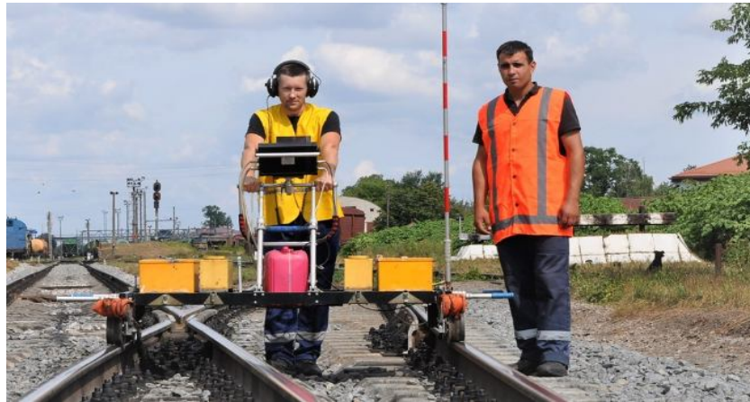
Рис. 1 – Застосування системи дефектоскопії на залізничних рейках
