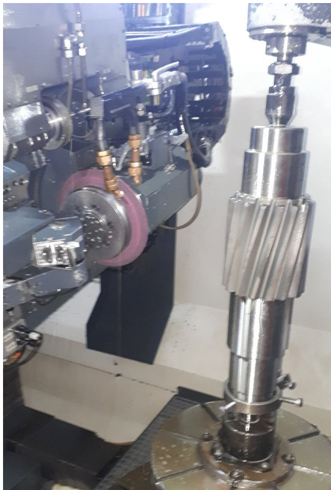
Рис. 1 – Установка шліфувального круга з рубін-корунду на верстат
